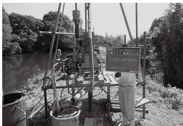
天山の重ね池、岡田の古池の土を採取するなどして耐震診断を行いました
