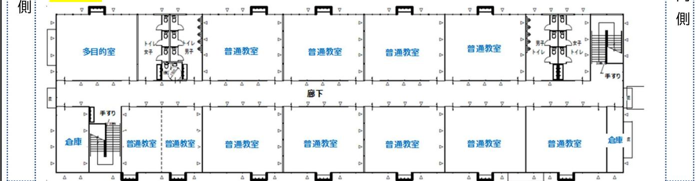
◇ 軽量鉄骨造2階建てのプレハブ校舎。普通教室 21 教室、1F に配膳室、2F に多目的室、また各階に倉庫、男女トイレ及び多目的トイレを配置します。
