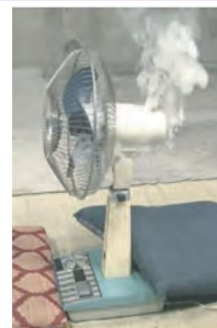
コンデンサーからの発煙 (NITEの再現実験)
