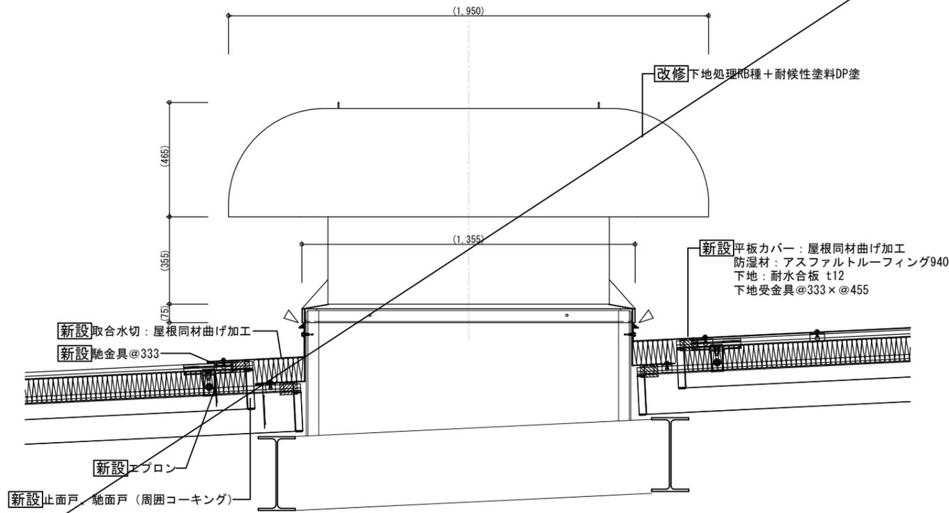
⑬ルーファン 桁行方向 詳細図 (改修)
