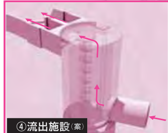
地下河川の水を河川へ排出する施設を整備します。
