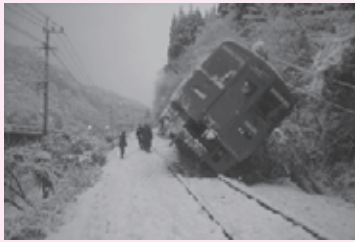
▲倒木により列車が脱線した事故
